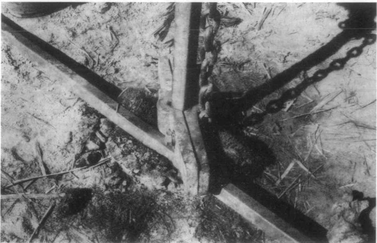
Abb. 2: Durch Dattelpalmstamm verschlossenes Bohrloch und vierkantiges Vollgestänge mit Gestängekrückel.
