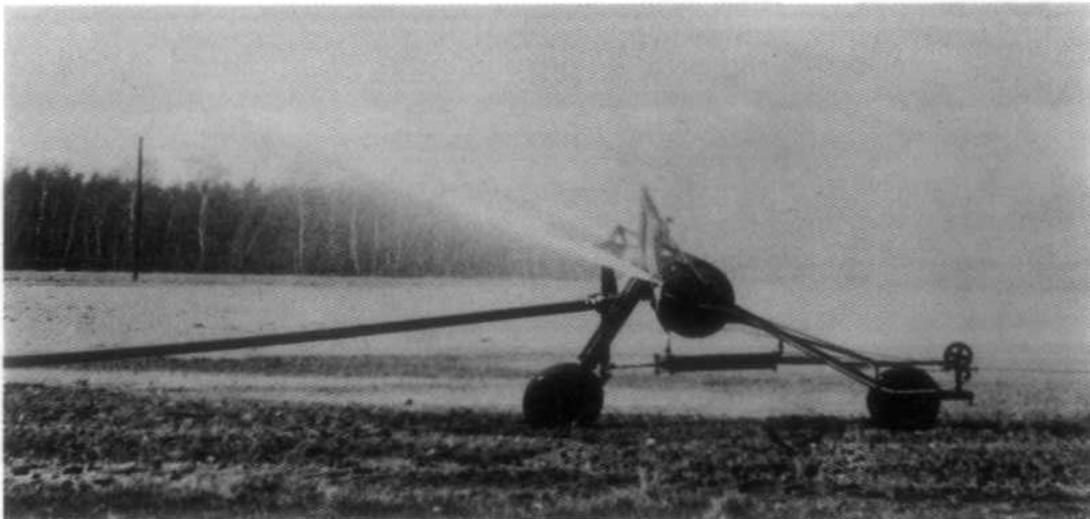
Abbildung 6: Beregnungsmaschine mit Maschinenvorschub
